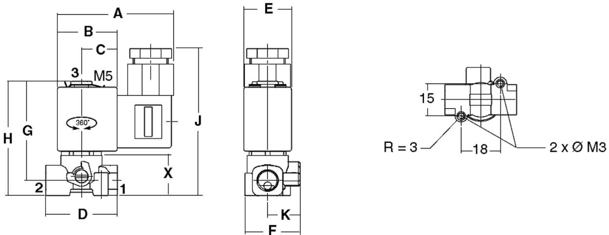
**Magnetventil, stromlos geschlossen, direktgesteuert**
